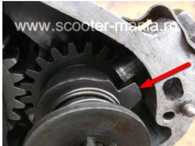
Si usted se centra en el eje irá por un tornillo a la derecha, en tales circunstancias, el mecanismo de parada que no va a funcionar.
