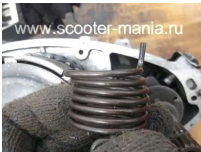
Y pegarlo en cualquier zarcillo en el agujero en la tapa del embrague. Luego tome un eje de transmisión, y de la mano estrías manivela le visten arandela de empuje.
