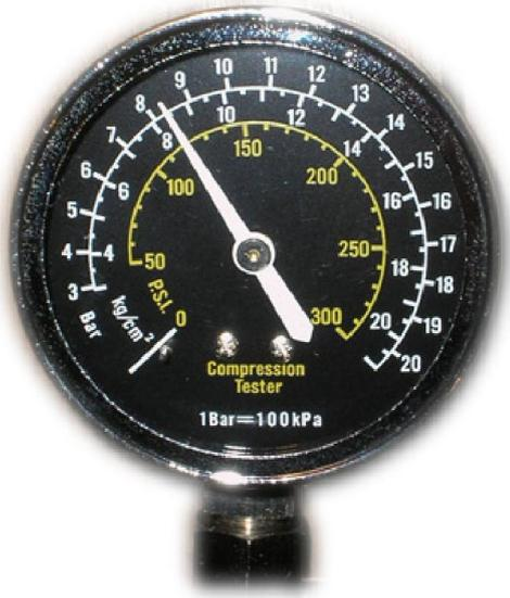
El instrumento de la foto esta graduado en tres escalas diferentes con sus respectivas unidades para medición de presión.
