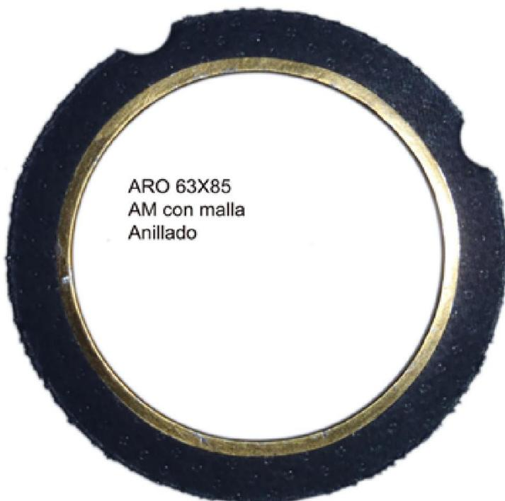
Junta sello de tapa de cilindro, TMZ 5.952. (Junta sello de culata) Pueden ser de laminado sintético con malla o, no recomendable, solamente una chapa de cobre o aluminio. En todos los casos se recomienda usar un sellador de junta de culata. (Head gasket sealer).
