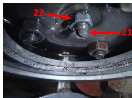
Posteriormente regulamos la holgura en la palanca del manubrio por medio de los toques con regulación que se encuentran en ambos extremos del forro de la linga.
