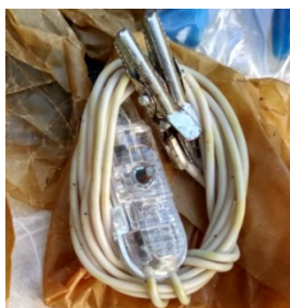
Foco de calibración. Es simplemente una lámpara de 5W con dos pinzas.
