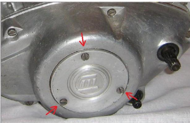
Quitar los tres tornillos y retirar la tapa de registro de embrague evitando dañar la junta de corcho.
