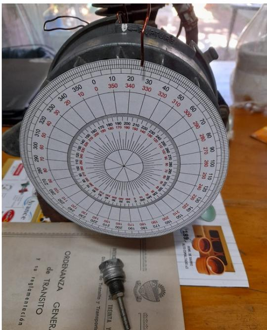
El disco graduado o goniómetro de 360° se fija al volante. Idealmente con escalas simétricas que permitan mediciones en todas las situaciones. Las lecturas se hacen siempre sobre la misma escala de 360°.
