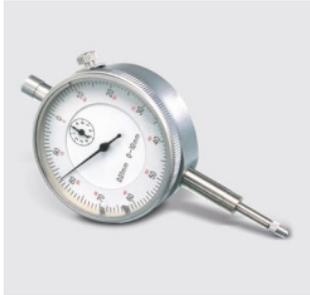
Éste método aplicado con esmero es preciso y adecuado para calibrar el sistema original con ruptor (platinos). El método se complementa con la técnica del foco o la hojilla de fumar que ponen en evidencia la separación de los contactos del ruptor.
