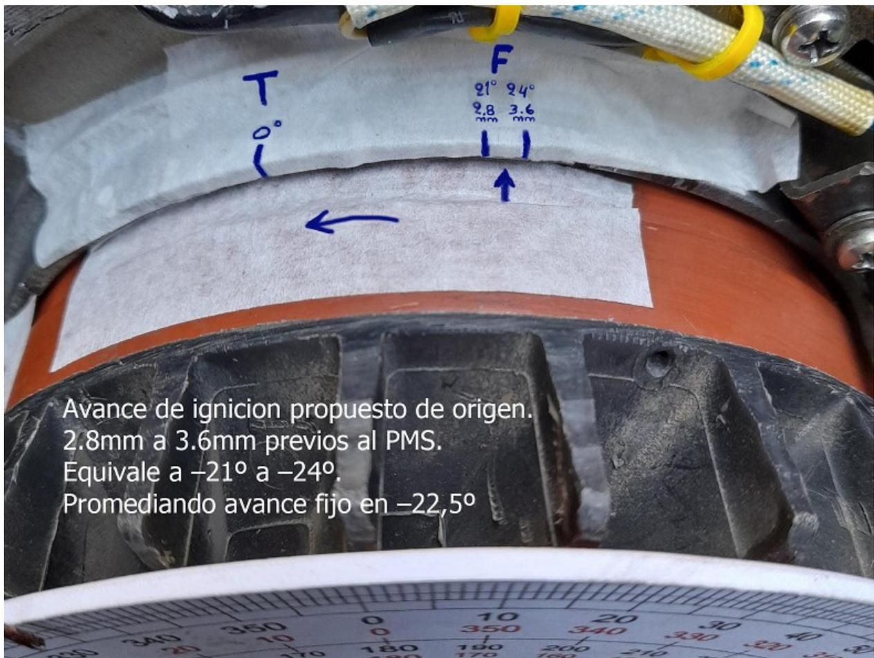
En la imagen se observan las marcas a 2.8mm equivalente a  $21^\circ$  y 3.6mm equivalente a  $24^\circ$ , entre las cuales debe producirse el disparo de ignición antes de que el pistón llegue al PMS en su giro anti horario.
