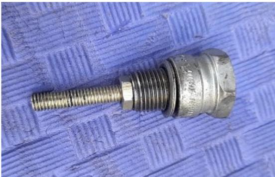
Se utiliza un útil (piston stopper), para topear el desplazamiento ascendente del embolo.
