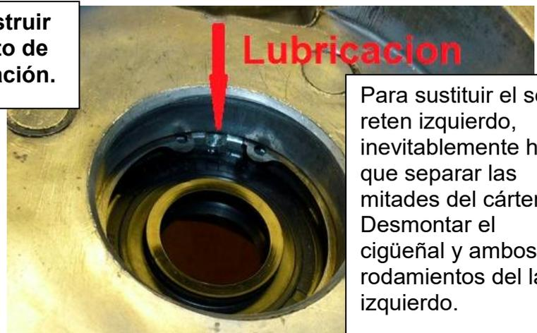
Para sustituir el sello reten izquierdo, inevitablemente hay que separar las mitades del cárter. Desmontar el cigüeñal y ambos rodamientos del lado izquierdo.
